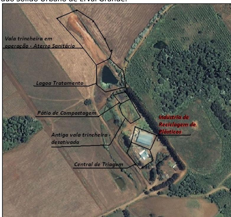
**Figura 10.2-XVI: Visão Geral da usina de reciclagem de Erval Grande**
