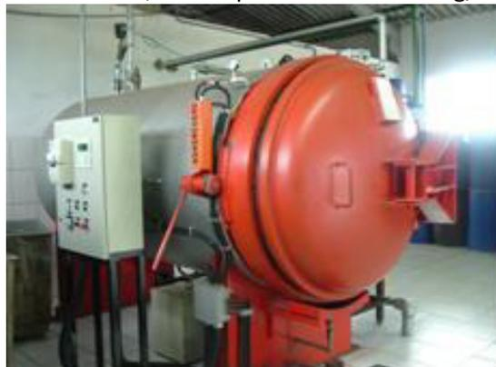
**Figura 10.2-LIV: Foto da autoclave (Fonte: Atitude Ambiental)**
