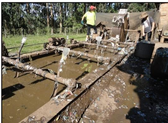
**Figura 10.2-LXXVI: Área de Lavagem do Plástico em processo de troca de água**
